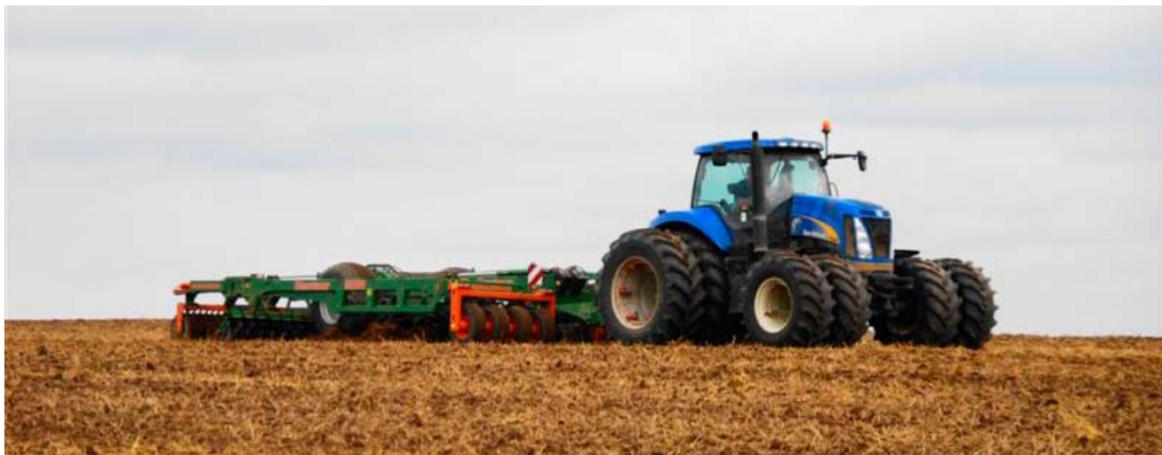
Põllu kobestamine talirapsi külviks Amazone firma sügavkobestiga.
